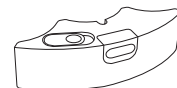
Rezervor de apă (instalați înainte de aspirare sau de a spăla cu mopul)
