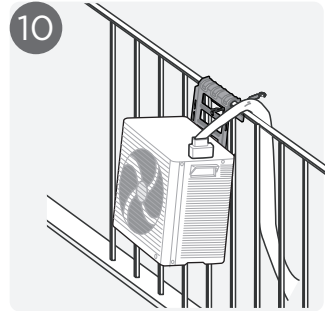
10 Przesunąć jednostkę zewnętrzną delikatnie do przodu, aż znajdzie się całkowicie we wsporniku i nie będzie można jej włożyć dalej. Montaż jest tym samym zakończony.
