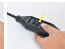
4. Tryck på knappen märkt «RESET», indikatorn lyser rött. Jordfelsbrytaren kommer nu fungera.
