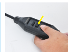
2. Tryck på knappen märkt «RESET», indikatorn kommer då lysa rött.
