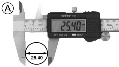
A. Pomiar powierzchni zewnętrznych
