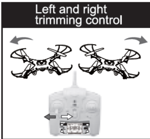
Trimming av venstre- og høyresnuing
